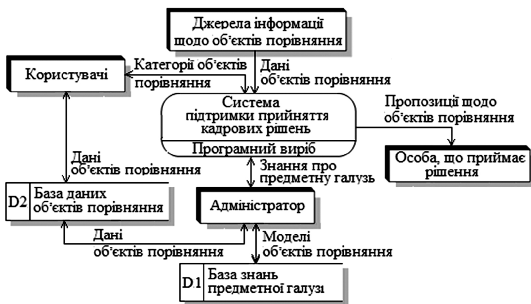
Рис. 1. Контекстна діаграма потоків даних системи підтримки прийняття рішень
