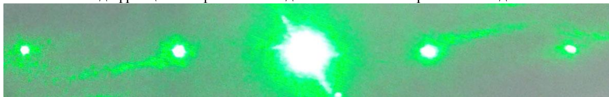
Рис.2. Фотографія відновленої голограми плоского хвильового фронту, що було зареєстровано в плівці на основі POSS-DY7 товщиною 0,6 мкм. ( e_1 \parallel e_2 , \varpi = 250 мм -1 , \eta \sim 1 %, центральна світлова пляма на фото відповідає «нульовому» порядку дифракції).
