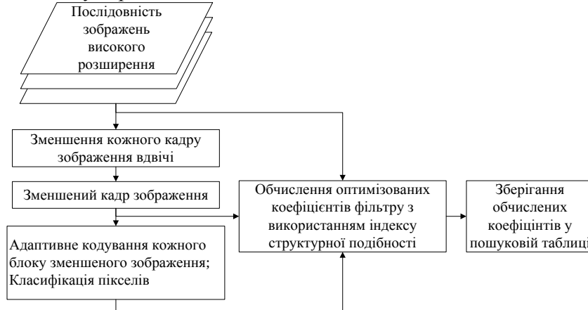
Рис. 3. Схема роботи алгоритму обчислення коефіцієнтів фільтра з використанням індексу структурної подібності
