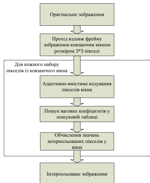
Рис. 1. Схема алгоритму адаптивного кодування з динамічними границями
