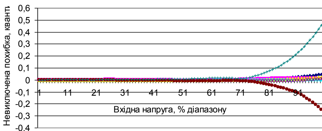
Рис. 3. Залежність невиключеної похибки нелінійності АЦП від вхідної напруги для відхилення резисторів \pm 1\% від номінального значення
