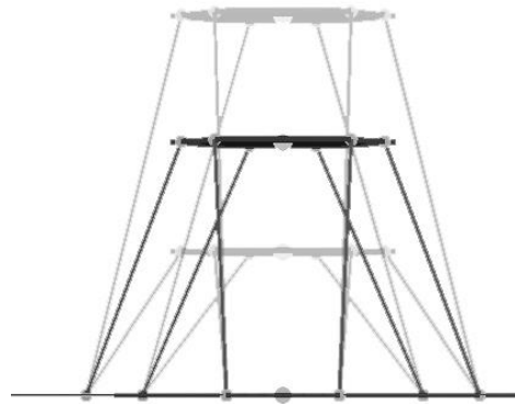
Рис. 2 Розміщення платформ при крайніх і середньому видовженні актуаторів.
