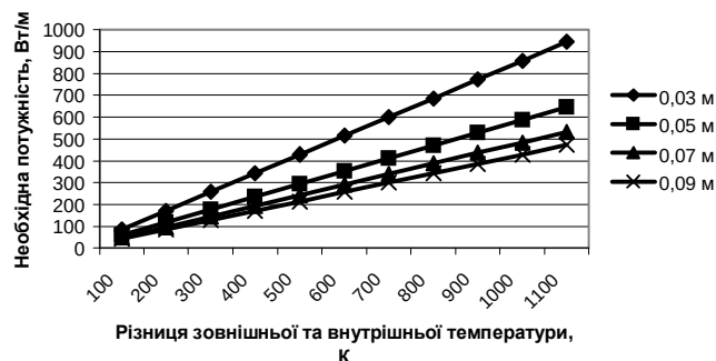
Рис. 2. Залежності максимальної погонної потужності нагрівачів ТЕП з КІТП від максимальної необхідної зміни температури та товщини шару теплоізоляції
