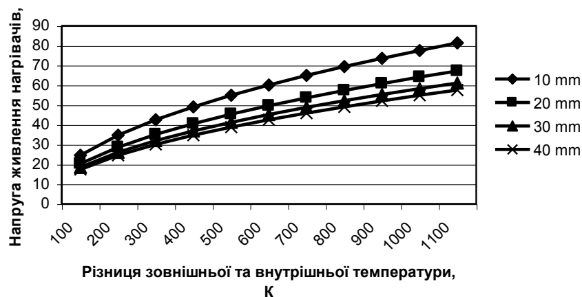
Рис. 3. Залежність необхідної напруги живлення нагрівача від товщини теплоізоляційного шару (мм)
