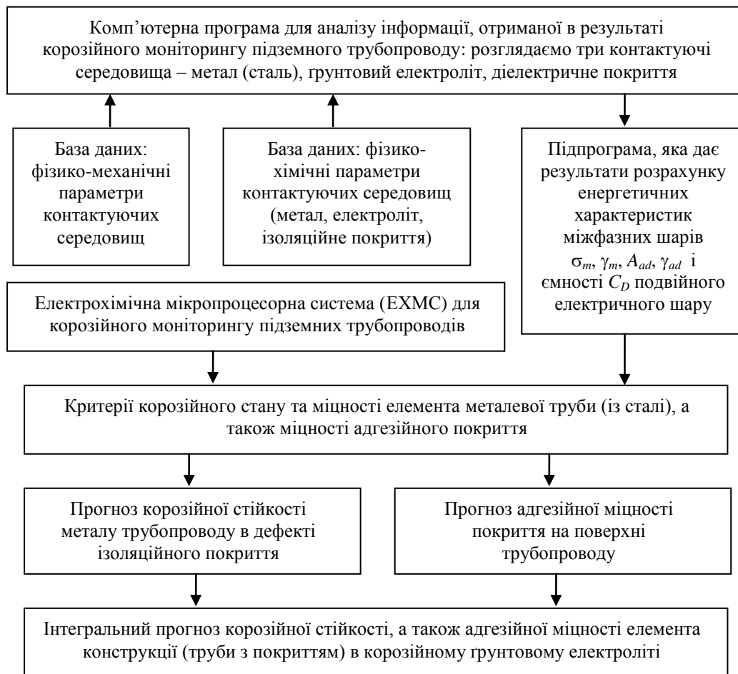
Рисунок. Блок-схема комп'ютерної програми для аналізу інформації, отриманої в результаті корозійного моніторингу підземного трубопроводу ( \sigma_m – міжфазний натяг, \gamma_m – міжфазна енергія, A_{ad} – робота адгезії, \gamma_{ad} – енергія адгезійних зв'язків)
