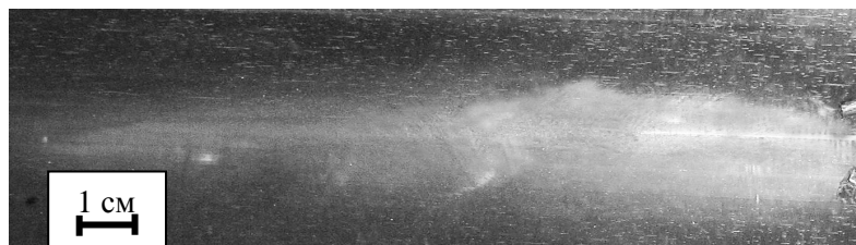
Рис. 3. Формування кавітаційного поля в струменевому кавітаторі із соплами (зйомка зі спалахом)
