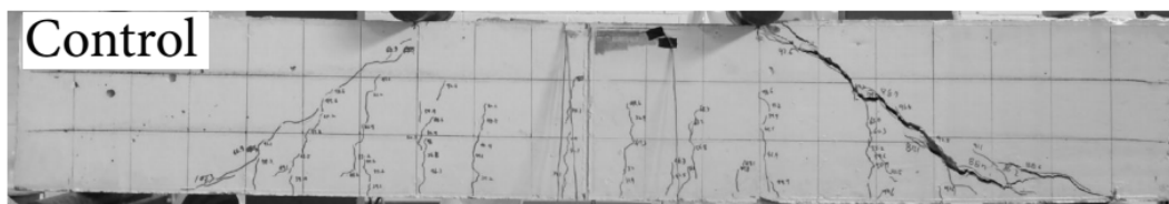
Рис. 5. Характер руйнування залізобетонної балки за поперечною силою [10]
