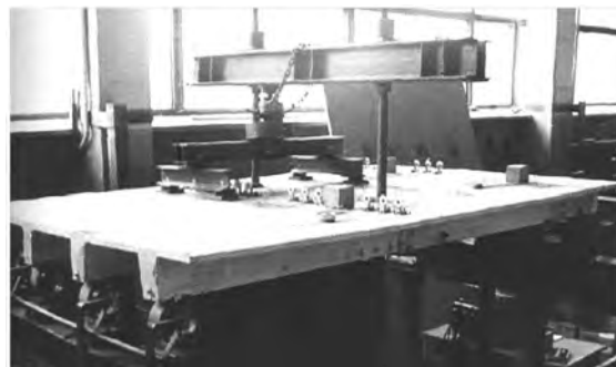
Фото 2. Загальний вигляд випробування прогонової будови без діафрагм
