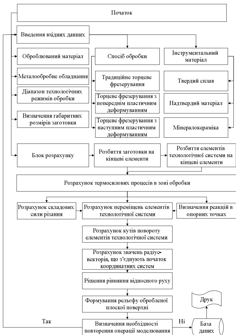
Рис. 4. Алгоритм роботи математичної моделі формування рельєфу обробленої пласкої поверхні комбінованим торцевим фрезеруванням
