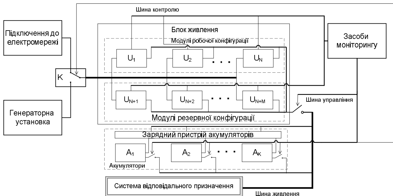
Рис. 1. Узагальнена структурно-функціональна схема відмовостійкого джерела безперебійного електроживлення
