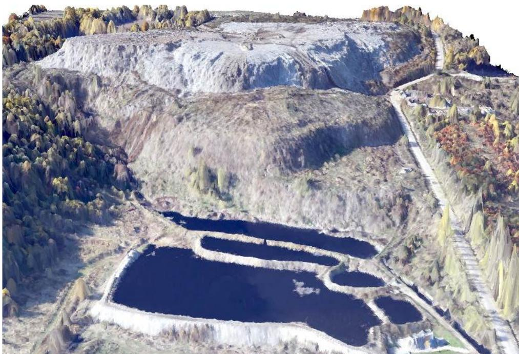
Рис. 10. Хмара точок з накладанням ортофотоплану полігону
