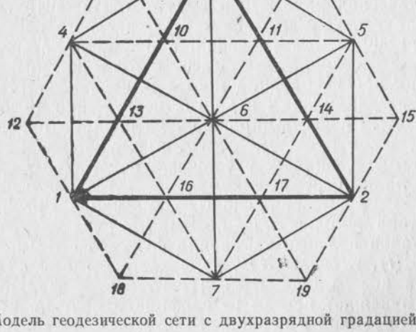
Модель геодезической сети с двухразрядной градацией.
