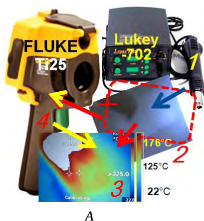
Рис. 4. Фотосхема експерименту. Розміри діагностичного IR-поля (4): А – 40х30 мм; В – 9.6х7.2 мм
