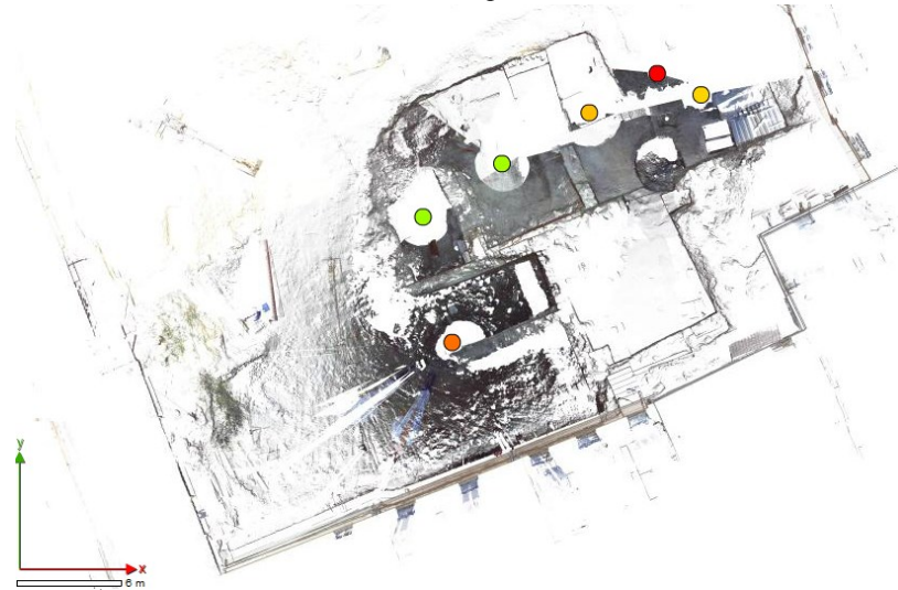
Рис. 4. Схема проведення робіт з наземного лазерного сканування.
