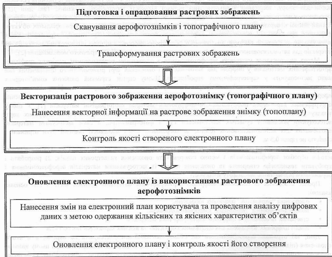
Рис.1. Загальна технологічна схема створення та оновлення кадастрових планів із застосуванням цифрових методів обробки аерофотознімків.
