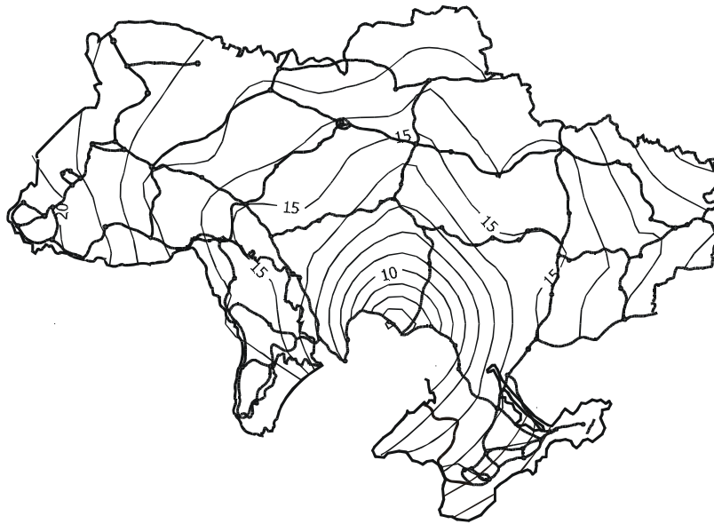
Рис. 3. Ізолінії похибок визначення висот пунктів нівелірної мережі першого класу, зумовлених випадковими похибками нівелювання (вихідний пункт – фундаментальний репер м. Миколаєва)
