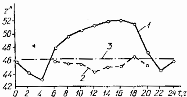
Рис. 1. График измеренных и редуцированных зенитных расстояний по линии Н-П:
