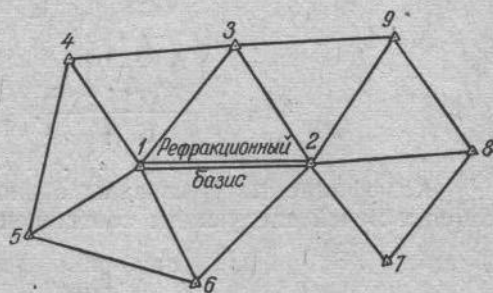
Рис. 2. Схема сети тригонометрического нивелирования с рефракционным базисом.
