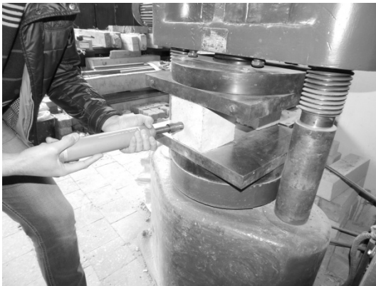
Рис. 3. Процес випробування взірця-куба методом пластичних деформацій
