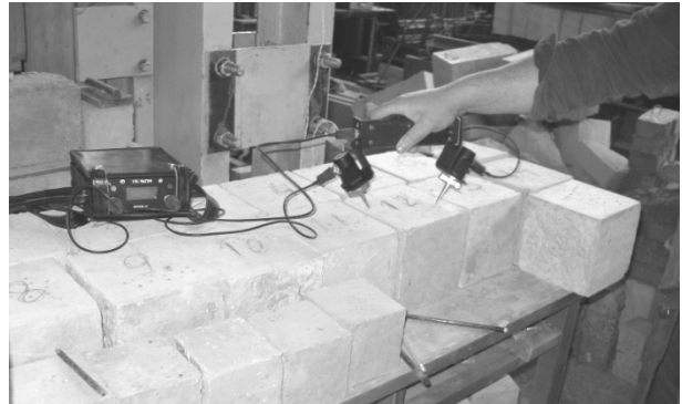
Рис. 2. Схема та загальний вигляд поверхневого прозвучування взірця-куба
