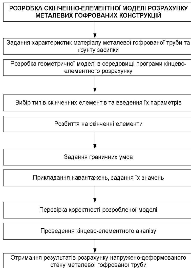
Рис. 1. Схема послідовності розрахунку напружено-деформованого стану металевих гофрованих конструкцій за допомогою МСЕ
