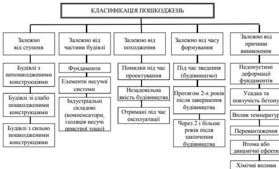
Рис. 1. Класифікація основних пошкоджень і дефектів будівельних конструкцій [3]
