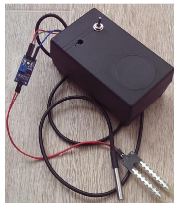
Рис. 4. Підсистема передавання даних про вологість та температуру ґрунту
