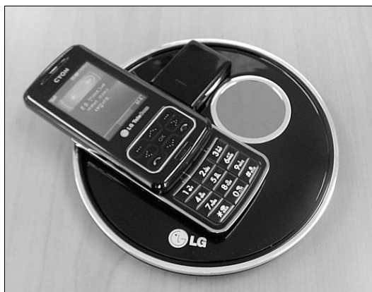
Рис. 9. Мобільний телефон для незрячих людей з механізмом захисту від несанкціонованого доступу NFC-Bluetooth
