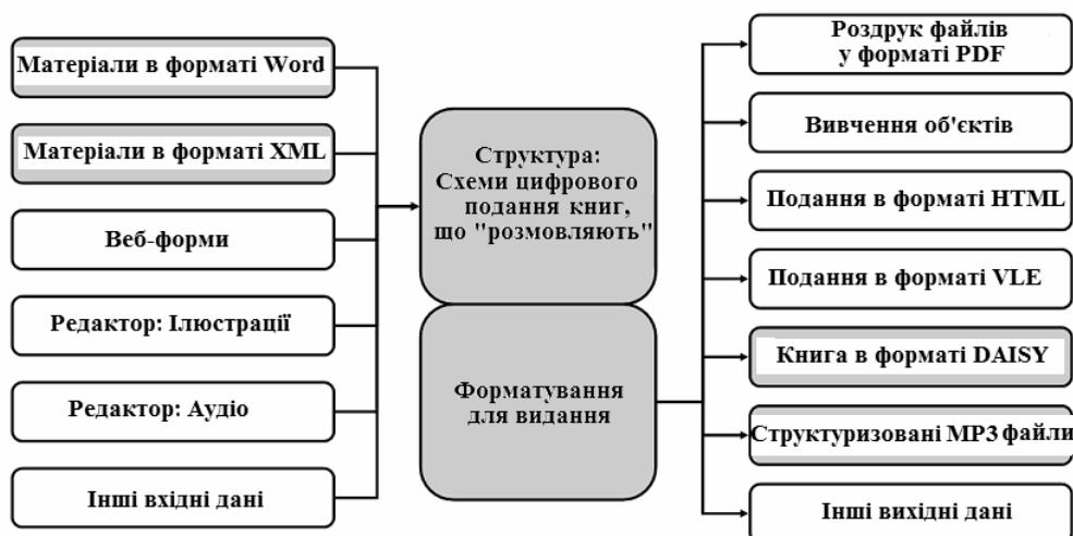
Рис. 3. Технологічний процес створення книжки, що “розмовляє”
