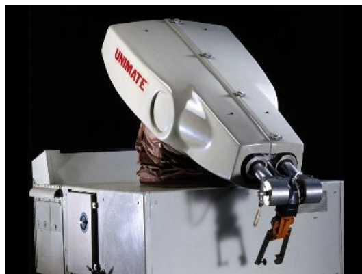
Рис. 12. Перший у світі програмований робот «UNIMATE»
