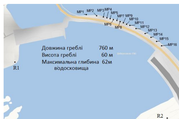
Рис. 4. Мережа ГНСС-пунктів на греблі Дніпровської ГЕС
