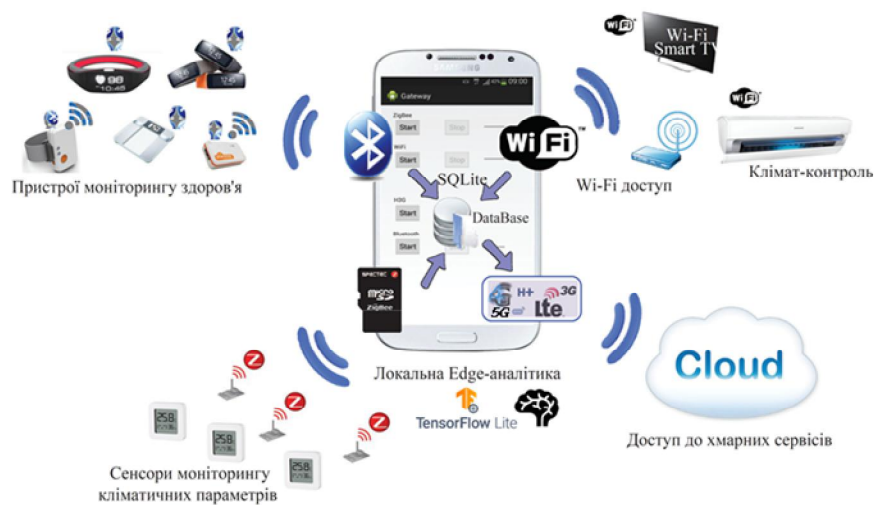
Рис. 2. Переваги використання смартфона як IoT шлюза для МКФС
