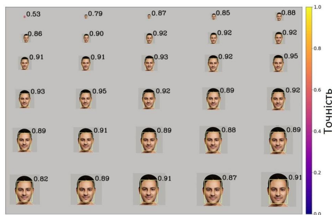
Рис. 6. Залежність точності для CenterFace від розміру зображення, який варіюється від 20 \times 20 до 310 \times 310 (px)
