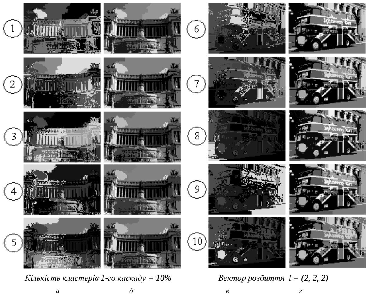
Рис. 3. Результати декомпозиції простору та каскадного згортання: 1– l = (2, 2, 1) ; 2– l = (2, 2, 2) ; 3– l = (4, 4, 1) ; 4– l = (4, 4, 2) ; 5– l = (4, 4, 4) ; 6–2%; 7–5%; 8–10%; 9–15%; 10–20%; a, в – кластери, розфарбовані випадковим кольором; б, г – кластери, розфарбовані їх зваженою яскравістю
