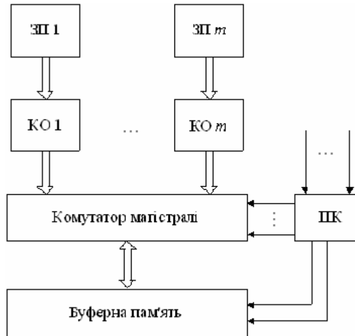
Структура пристрою обміну з буферизацією даних
